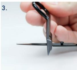
3. Nach erfolgter Aufbereitung werden die beiden Scherenteile dann in umgekehrter Reihenfolge (entsprechend der Bilder 1 -2 -3) wieder zusammen gesetzt
