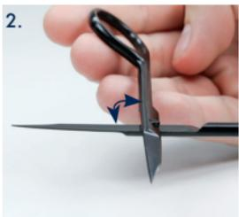
2. Heben sie den oberen Teil der Schere kurz an (ca. 45°) und lösen die beiden Scherenteile voneinander - FERTIG
