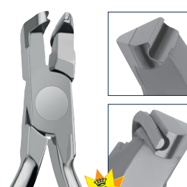
OLS-1114 - mit Fangvorrichtung - bündiges Schneiden zum Bracket oder Bukkalröhrchen - with safety hold - Cuts flush to the bracket or buccal tube max. 0,56mm x 0,70mm / .022" x .028"
