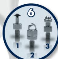
Für Lochstopfen werden primär die Wechselspitzen 1 + 3 verwendet und für glatte Kanülenstopfen die Spitze 2. Die Arretierung der Wechselspitzen 1 + 3 im Lochstopfen erfolgt durch einen kurzen und kräftigen Druck mittels des Kolbenstangenrings. Bei glatten Kanülenstopfen und der Anwendung mittels der Wechselspitze 2 werden die Krallen an den Kanülenstopfen herangedrückt und durch Drehung des Kolbenstangenrings in dem Kanülenstopfen fixiert. Nach der korrekten Fixierung der jeweiligen
